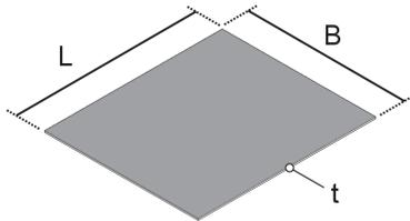
Bei den Produktlösungen UEK V handelt es sich um viereckige Deckeinlagen aus dem Portfolio der Unterflursysteme. Die Montageelemente werden in eckige Kunststoff-Klappdeckeleinheiten eingesetzt, um dort Bodenbelagsausparungen zu verringern. Die Deckeinlagen werden aus Karton oder aus Polyvinylchlorid gefertigt. Beide Modelle sind 210 mm breit und 243 mm lang.
