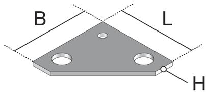
Bei den Bauelementen UEBSVMB S handelt es sich um Eckverbinderbleche für estrichbündige Kanäle. Diese Produktlösungen werden zusätzlich zu den Eckverbindern in die Kanalprofile eingesetzt. Mithilfe der passenden Schrauben werden sie in die Ecken montiert und bilden so den notwendigen Befestigungspunkt. Die Verbinderbleche sind aus sendzimir-feuerverzinktem Stahlblech (DIN EN 10346) in einer Höhe von 2 mm und einer Breite sowie Länge von 40 mm gefertigt.
