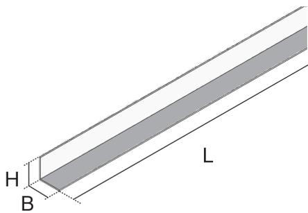
Bei den Bauelementen UEBSTR handelt es sich um Trennstege für estrichbündige Kanalsysteme. Sie werden in die Kanäle verschraubt und dienen dort zur sicheren räumlichen Trennung der Stromkabel von anderen Einbauelementen, wie zum Beispiel Datenträgern oder Gerätebechern. Die Produktlösungen werden aus dem Kunststoff Polyamid gefertigt und sind in einem Längenmaß von 2000 mm erhältlich.
