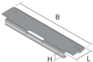
Bei den Bauelementen UEBSQTF S handelt es sich um Quertraversen für estrichbündige Kanäle, die der Unterstützung von Deckelstößen dienen. Die Produktlösungen werden aus sendzimir-feuerverzinktem Stahlblech nach DIN EN 10346 hergestellt und inklusive zweier Senkkopfblechschrauben BSS 4.8 x 16 geliefert.
