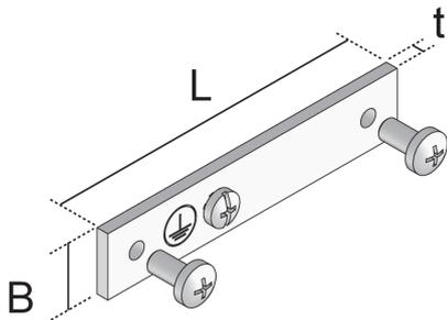
Bei den Bauelementen UEBSE handelt es sich um Erdungsverbinder für estrichbündige Kanäle. Im Zuge der Kanalwannenerdung sorgen die Verbinder für einen sicheren Anschluss von Erdungs- und Potentialausgleichsleitungen. Für eine erfolgreiche Montage werden zwei Linsenkopfschrauben LKS M5X10 und eine Linsenkopfschraube LKS M4X5 beigefügt. Die Verbinder sind aus sendzimir-feuerverzinktem Stahlblech nach DIN EN 10346 gefertigt.
