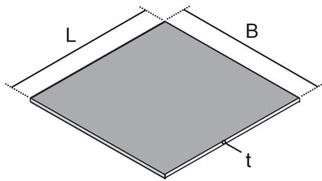
Bei den Bauelementen UEBDE V handelt es sich um viereckige Deckeinlagen. Diese Zubehörteile werden als Füllstück zur Verringerung der Bodenbelageeinlagetiefe in Edelstahlblindkassetten eingesetzt, welche sich mit bis zu drei Gerätebechern bestücken lassen. Die weißen Deckeinlagen aus dem Sortiment der Einbaueinheiten für Unterflursysteme sind aus hochwertigem Polyvinylchlorid Hartschaum gefertigt. Sie sind mit einer Breite und Länge von 245 mm und einer Materialstärke von 6,0 erhältlich.
