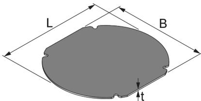
Bei den Produktlösungen UEBD R handelt es sich um Zubehör aus dem Portfolio der Unterflursysteme. Diese runden Deckeinlagen werden in runde Kunststoffblinddeckel eingesetzt, um dort Bodenaussparungen zu verringern. Die Zubehörelemente werden aus hochwertigem Karton gefertigt und besitzen eine Breite von 176 mm und eine Länge von 247 mm. Sie sind in einer Materialstärke von 3 mm erhältlich.
