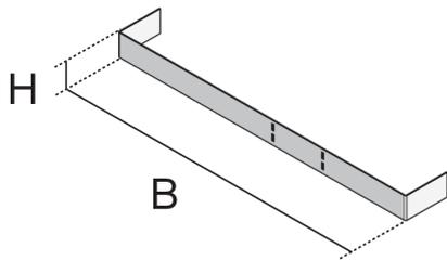
Bei dem Bauelement UE handelt es sich um Endstücke, die bei der Montage estrichüberdeckter Unterflurkanäle eingesetzt werden. Durch das Umbiegen an der perforierten Linie auf dem Bauteil können die Endstücke in die Kanalenden geschoben werden und bilden dort einen sicheren Verschluss. Dabei sind sie passend für Kanalbreiten von 190, 250 und 350 mm ausgelegt. Die Endstücke werden aus sendzimir-feuerverzinktem Stahlblech nach DIN EN 10346 gefertigt.
