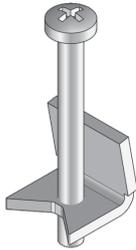
Bei den Bauelementen UDKS R 1 handelt es sich um Universalkralle aus dem Portfolio der Einbaueinheiten für Unterflursysteme. Die Zubehörteile werden mithilfe der beigelegten Linsenkopfschraube im Schutzrahmen der Einzelauslässe BODO N eingehängt und sorgen für deren sichere Verbindung. Sie sind zum Einbau in Estrich-, Doppel- und Hohlrumböden geeignet. Die Krallen werden aus sendzimir-feuerverzinktem Stahlblech, nach DIN EN 10346, gefertigt und besitzen einen Klemmbereich von 16 - 20 mm.
