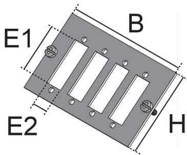
Bei den Bauelementen UDEP SCD handelt es sich um Einbauplatten aus dem Sortiment der Unterflursysteme. Die Platten werden in Datengeräteträger eingeschraubt und dienen dort der Aufnahme von bis zu 4 Einzelinstallationsgeräten zur Lichtwellenleitung des Typs SC-Duplex. Die Einbauplatten sind aus einseitig schwarz beschichtetem Aluminium gefertigt und können mit dem Einbaumaß E1 von 26.4 mm und E2 von 9.8 mm erworben werden.
