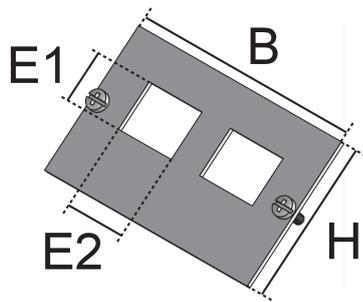
Bei den Bauelementen UDEP RMSC 2 handelt es sich um Einbauplatten aus dem Sortiment der Unterflursysteme. Die Platten werden in Datengeräteträger eingeschraubt und dienen dort zur Aufnahme von bis zu 2 Snap-in-Datenjacks des Herstellers R&M. Die Einbauplatten sind aus einseitig schwarz beschichtetem Aluminium gefertigt und können mit dem Einbaumaß E1 von 14.9 mm und E2 von 19.5 mm erworben werden.
