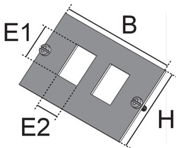
Bei den Bauelementen UDEP KR handelt es sich um Einbauplatten aus dem Sortiment der Unterflursysteme. Die Platten werden in Datengeräteträger eingeschraubt und dienen dort zur Aufnahme von bis zu 2 Datenjacks von ADC KRONE oder Stecktechnikkomponenten anderer Hersteller wie Dätwyler, Telegärtner oder Brand-Rex. Die Einbauplatten sind aus einseitig schwarz beschichtetem Aluminium gefertigt und können mit dem Einbaumaß E1 von 19.4 mm und E2 von 14.8 mm erworben werden.
