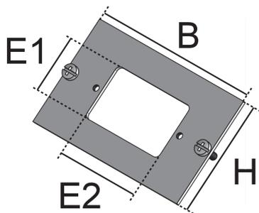
Bei den Bauelementen UDEP KM handelt es sich um Einbauplatten aus dem Sortiment der Unterflursysteme. Die Platten werden in Datengeräteträger eingeschraubt und dienen dort der Aufnahme einer Anschlussblende für Audio- oder Videotechnik des Typs connect 50 alu/50 steel des Herstellers Kindermann. Die Einbauplatten sind aus einseitig schwarz beschichtetem Aluminium gefertigt und können mit dem Einbaumaß E1 von 23 mm und E2 von 38 mm erworben werden.
