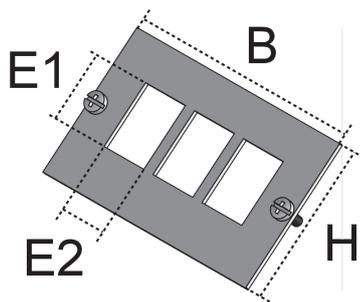
Bei den Bauelementen UDEP HAR handelt es sich um Einbauplatten aus dem Sortiment der Unterflursysteme. Die Platten werden in Datengeräteträger eingeschraubt und dienen dort zur Aufnahme von maximal 3 Datenjacks des Herstellers Harting. Die Einbauplatten sind aus einseitig schwarz beschichtetem Aluminium gefertigt und können dem Einbaumaß E1 von 19.1 mm und E2 von 14.7 mm erworben werden.
