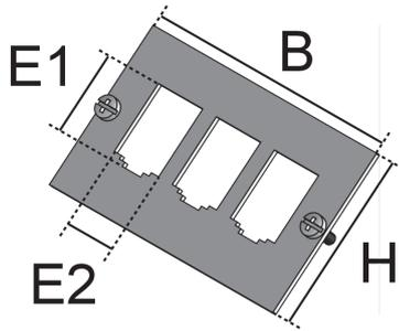
Bei den Bauelementen UDEP BTR handelt es sich um Einbauplatten aus dem Sortiment der Unterflursysteme. Die Platten werden in Datengeräteträger eingeschraubt und dienen dort zur Aufnahme von maximal 3 BTR-Datenjacks. Die Einbauplatten sind aus einseitig schwarz beschichtetem Aluminium gefertigt und können mit dem Einbaumaß E1 von 19,35/21,55 mm und E2 von 14.85 mm erworben werden.
