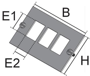
Bei den Bauelementen UDEP AMP SL handelt es sich um Einbauplatten aus dem Sortiment der Unterflursysteme. Die Platten werden in Datengeräteträger eingeschraubt und dienen dort zur Aufnahme von bis zu 3 AMP-TWIST 7AS SL- oder AMP-TWIST 7AS SL-Datenjacks von TE Connectivity. Die Einbauplatten sind aus einseitig schwarz beschichtetem Aluminium gefertigt und können mit dem Einbaumaß E1 von 20.25 mm und E2 von 14.78 mm erworben werden.
