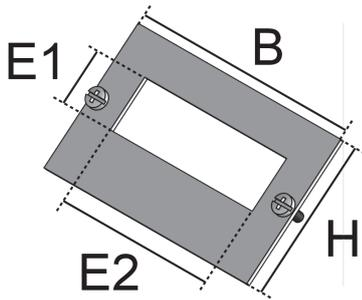
Bei den Bauelementen UDEP 5PK handelt es sich um Einbauplatten aus dem Sortiment der Unterflursysteme. Die Platten werden in Datengeräteträger eingeschraubt und dienen dort zur Aufnahme einer 5-poligen Snap-in-Steckverbinderbuchse oder eines Snap-in-Steckers mit 400V und 16 A. Die Einbauplatten sind aus einseitig schwarz beschichtetem Aluminium gefertigt und können mit dem Einbaumaß E1 von 16.6 mm und E2 von 52.5 mm erworben werden.
