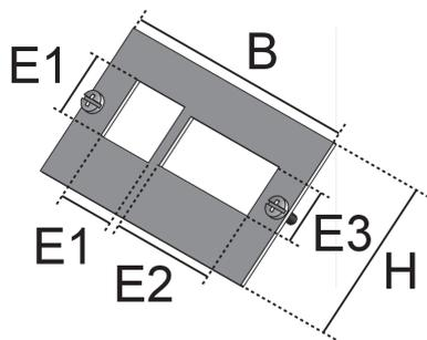
Bei den Bauelementen UDEP 3PK handelt es sich um Einbauplatten aus dem Sortiment der Unterflursysteme. Die Platten werden in Datengeräteträger eingeschraubt und dienen dort zur Aufnahme von bis zu drei 2-poligen Snap-in-Steckverbinderbuchsen von Wieland mit 250V und 16 A. Die Einbauplatten sind aus einseitig schwarz beschichtetem Aluminium gefertigt und können mit dem Einbaumaß E1 von #AW.E1# mm, E2 von 33 mm und E3 von 15.6 mm erworben werden.
