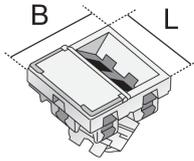
Bei den Bauelementen UDAE45 handelt es sich um 2-fache Datenanschlussdosen aus dem Sortiment der Installationsgeräte für Unterflursysteme. Die 8-poligen Anschlussdosen entsprechen dem Typ CAT6U 8/8, RJ45 und können für ungeschirmte UTP-Netzwerkkabel (Unshielded Twisted Pair) verwendet werden. Sie lassen sich in Installationsöffnungen mit einer Größe von 45x45 mm einrasten. Die Datendosen sind aus Polycarbonat in der Farbe Weiß gefertigt.
