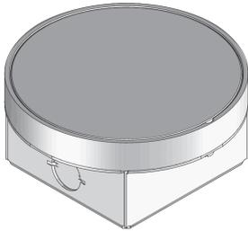
Runde Reinigungssteckdose aus Aluminium mit Stoßkante. Inkl. weißer 1-facher Schutzkontaktsteckdose. Als nivellierbare Einheit mit Tubusdeckel, Aufnahmegehäuse aus Stahlblech. Zum direkten Einbau in Estrichböden. Für Räume mit geringem Fußbodenaufbau und nass gepflegten Bodenbelägen geeignet. Ausgelegt für Büroverkehrslasten.
