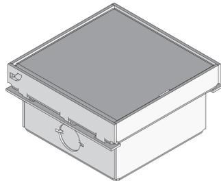
Eckige Reinigungssteckdose aus Edelstahlblech mit Stoßkante und plane Kabelauslass-Kassette. Plane Oberfläche gestrahlt. Inkl. weißer 1-facher Schutzkontaktsteckdose. Als nivellierbare Einheit mit Kassettendeckel, Aufnahmegehäuse aus Stahlblech. Zum direkten Einbau in Estrichböden. Für Räume mit geringem Fußbodenaufbau und nass gepflegten Bodenbelägen geeignet. Ausgelegt für Büroverkehrslasten.
