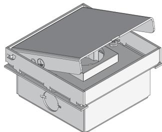
Eckige Reinigungssteckdose aus Edelstahlblech mit Stoßkante. Inkl. weißer 1-facher Schutzkontaktsteckdose. Als nivellierbare Einheit mit Kassettendeckel, Aufnahmegehäuse aus Stahlblech. Zum direkten Einbau in Estrichböden. Für Räume mit geringem Fußbodenaufbau und trocken bis feucht gepflegten Bodenbelägen geeignet. Ausgelegt für Büroverkehrslasten.
