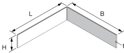
Das Bauteil UBSFPTMA ist ein Belagstoßprofil aus Edelstahl für den Estrichbündigen Kanal UBSF. Das Profil ist bestimmt für die Montagesätze 90°-Bogen, T-Abzweig und Kreuzung. Geeignet für Belagsniveau von 0 bis 3 mm. Das Bauteil entspricht der DIN EN 50085 – der europäischen Norm für Elektroinstallationskanalsysteme, und ist vom VDE geprüft und zertifiziert.
