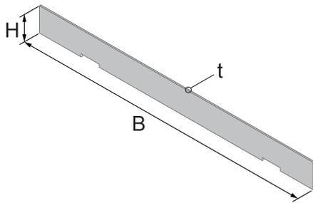
Das Bauteil UBSFPTES ist ein Belagstoßprofil aus Edelstahl für das nivellierbare Endstück für den Estrichbündigen Kanal UBSF als Wendeprofil für 0 und 3 mm Belagsniveau. Das Bauteil entspricht der DIN EN 50085 – der europäischen Norm für Elektroinstallationskanalsysteme, und ist vom VDE geprüft und zertifiziert.
