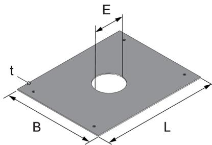
Das Bauteil UBSFMD4 R ist ein Montagedeckel für den Estrichbündigen Kanal UBSF zur Bestückung von runden Einheiten. Er ist aus feuerverzinktem Stahlblech gefertigt, hat eine Länge von 500 mm und ist in den Breiten 200 bis 600 mm erhältlich. Das Bauteil entspricht der DIN EN 50085 – der europäischen Norm für Elektroinstallationskanalsysteme, und ist vom VDE geprüft und zertifiziert.
