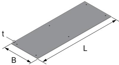
Das Bauteil UBSFD4 ist ein Blinddeckel für den Estrichbündigen Kanal UBSF. Er ist aus feuerverzinktem Stahlblech gefertigt, hat eine Länge von 500 bzw. 1.000 mm und ist in den Breiten 200 bis 600 mm erhältlich. Das Bauteil entspricht der DIN EN 50085 – der europäischen Norm für Elektroinstallationskanalsysteme, und ist vom VDE geprüft und zertifiziert.
