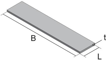
Bei den Bauteilen UBKDB handelt es sich um Distanzbleche, die ein Element estrichbündiger Schwerlastkanäle sind. Im Zuge der Montage werden die Bleche vor der Estricheinbringung in die vormontierten Seitenprofile der Kanalunterseiten eingesetzt und nach Estrichhärtung wieder entfernt. Sie sind aus sendzimir-feuerverzinktem Stahlblech gemäß DIN EN 10346 gefertigt und in einer Länge von 60 mm, einer Materialstärke von 4 mm und diversen Breitenabmessungen erhältlich.
