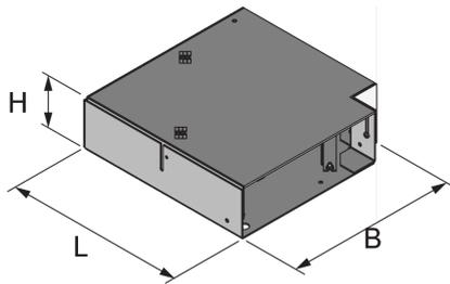
Teil des Sortiments der estrichbündigen Bürstenkanäle sind die Außenbögen UBEBMBA. Diese Produktlösungen dienen als Verbindungsstücke zwischen zwei Kanalteilen. Aufgrund ihrer Winkelform ermöglichen sie, dass Leitungen auch in einer außenliegenden 90 Grad Verwinkelung verlegt werden können. Diese Bauelemente sind aus sendzimir-feuerverzinktem Stahlblech gemäß DIN EN 10346 gefertigt und in einer Länge sowie Breite von 297 mm erhältlich.
