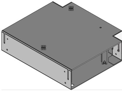
Der T-Abzweig UBEEMAR ist ein Bauelement aus dem Sortiment des estrichbündigen Bürstenkanals CHALI. Diese Produktlösung dient als Verbindungsstück zwischen zwei Kanalteilen. Dank ihrer T-Form können Leitungen innerhalb eines Kanalabschnitts entsprechend der gewünschten Richtung verlegt werden. Das Bauelement ist aus sendzimir-feuerverzinktem Stahlblech gemäß DIN EN 10346 gefertigt.
