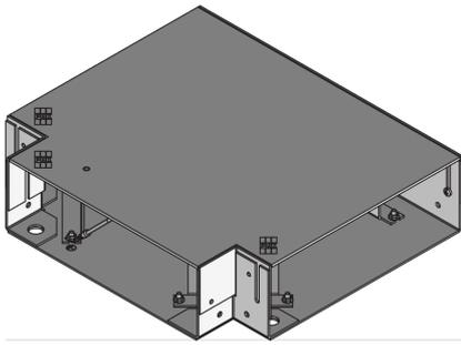
Der T-Abzweig UBEBMAIL ist ein Bauelement aus dem Sortiment des estrichbündigen Bürstenkanals CHALI. Diese Produktlösung dient als Verbindungsstück zwischen zwei Kanalteilen. Dank ihrer T-Form können Leitungen innerhalb eines Kanalabschnitts entsprechend der gewünschten Richtung verlegt werden. Das Bauelement ist aus sendzimir-feuerverzinktem Stahlblech gemäß DIN EN 10346 gefertigt..
