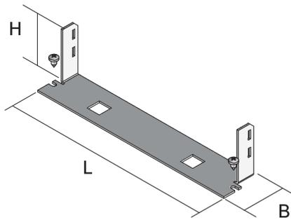
Bei den Produktlösungen UBEBGT handelt es sich um Elemente zur Aufnahme von Gerätebechern und Datenträgern innerhalb der estrichbündigen Kanalsysteme CHALI, welche in den Bürstenkanal verschraubt werden. Diese Montagekomponenten werden aus sendzimir-feuerverzinktem Stahlblech gemäß DIN EN 10346 gefertigt und sind in einer Länge von 244 mm, einer Breite von 45 mm und einer Höhe von 63 mm erhältlich. Sie besitzen eine VDE/TÜV-Zulassung gemäß DIN EN 50085.
