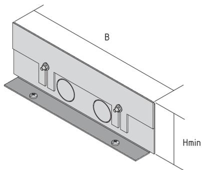
Bei den Produktlösungen UBE BES handelt es sich um variable Endstücke, die dem Verschluss der estrichbündigen Bürstenkanäle CHALI dienen. Die Montagekomponenten sind nivellierbar und passen sich an eine Bodenbelagstärke von 25 mm an. Sie werden aus sendzimir-feuerverzinktem Stahlblech gemäß DIN EN 10346 gefertigt und sind mit einer minimalen Einbauhöhe von 80 mm und einer Breite von 250 mm erhältlich.
