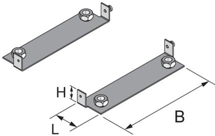
Das Befestigungsset UBEBBS zum Brandschutzschott CHALI gehört zu den Montagekomponenten der estrichbündigen Bürstenkanäle. Bei diesen Produktlösungen handelt es sich um eine Traverse, die der Befestigung der Brandschotts an die Unterflurkanäle dient. Diese Trägerelemente sind aus sendzimir-feuerverzinktem Stahlblech gemäß DIN EN 10346 gefertigt und in einer Breite von 160 mm erhältlich.
