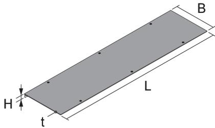
Bei den Baukomponenten UBEBBDL handelt es sich um ein verschraubbares Blinddeckel-Set für das estrichbündige Kanalsystem CHALI. Verwendbar für die CHALI-Bodenwanne und bei Türquerungen im Austausch mit einem Scharnierdeckel. Diese Produktlösung wird aus sendzimir-feuerverzinktem Stahlblech nach DIN EN 10346 gefertigt. Die Produktlösung ist für gängige Bürolasten ausgelegt. Das Set wird inklusive sechs galvanisch-verzinkter (gemäß DIN EN ISO 4042) Senkkopfblechschrauben BSS 4.8 x 16 geliefert.
