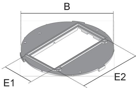
Bei den Bauelementen UARM-4-1 aus dem Produktportfolio der Unterflursysteme handelt es sich um runde, einteilige Abdeckplatten mit einer viereckigen Aussparung. In die Aussparung können zwei rastbare Installationsgeräte mit dem Maß 45x45 mm eingebaut werden. Die Platten werden aus hochwertigem Acrylnitril-Butadien-Styrol-Copolymerisat (ABS) in der Farbe Graphitschwarz (RAL 9011) gefertigt. Sie sind mit einem Einbaumaß E1 von 40.5 mm und E2 von 86 mm erhältlich.
