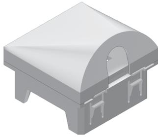
Bei dem Bauelement UAPAM45 handelt es sich um 1-fache Kabelausslässe aus dem Sortiment der Installationsgeräte für Unterflursysteme. Diese Auslässe können in Installationsöffnungen mit den Maßen 45x45 mm eingerastet werden. Sie dienen als stabile Zugentlastung für Kabel mit einem maximalen Durchmesser von 6mm. Die UAPAM45 sind aus hochwertigem Polycarbonat in der Farbe Weiß gefertigt.
