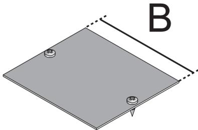
Bei den Bauelementen UAA B 65 handelt es sich um Abdeckplatten aus dem Sortiment der Unterflursysteme. Sie werden auf einen Geräteträger geschraubt um dort die Einbauöffnung abzudecken und ihn dadurch vor diversen, äußeren Einflüssen zu schützen. Die einteiligen Platten sind aus sendzimir-feuerverzinktem Stahl nach DIN EN 10346 gefertigt und sind in der Farbe Schwarz (ähnlich RAL 9011) erhältlich.
