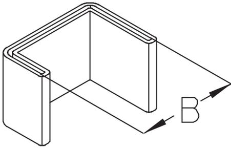
Die Schutzkappen SU 50/36 eignen sich für Steigetrassen STU 50 und werden je nach Gegebenheiten auf die Steigetrassenholme geschoben. Sie bestehen aus Polyethylen und haben eine der Holmhöhe entsprechende Breite von 50 mm. (Nicht bei STU 50-3E einsetzbar.)
