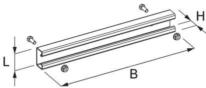
Die Sprossen STLS können im Zuge der Steigetrasse montage zusätzlich eingebaut und mit dem Seitenholm verschraubt werden. Sie eignen sich für die Steigetrasse STU 50 und haben eine der Steigetrassebreite entsprechende Breite von 203 bis 793 mm. Verschiedene Materialien und Oberflächen sorgen dafür, dass die Korrosionsanforderungen unterschiedlichster Anwendungsgebiete erfüllt werden.
