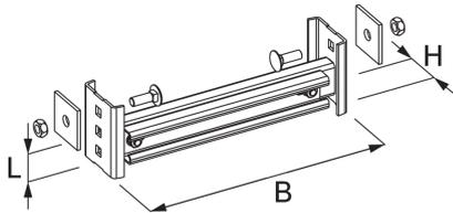
Die Sprossen STISD werden im Zuge der Steigetrassenmontage eingebaut und mit dem Seitenholm verschraubt. Sie eignen sich für die Steigetrassen ST 82 zur beidseitigen Kabelbelegung. Sie haben eine der Steigetrassenbreite entsprechende Breite von 200 bis 1200 mm und bestehen aus tauchfeuerverzinktem Stahl.
