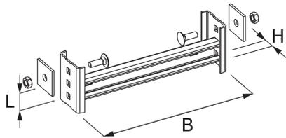
Die Sprossen STIS werden im Zuge der Steigetrassenmontage eingebaut und mit dem Seitenholm verschraubt. Sie eignen sich für die Steigetrassenbreite entsprechende Breite von 200 bis 1200 mm und bestehen aus tauchfeuerverzinktem Stahl.
