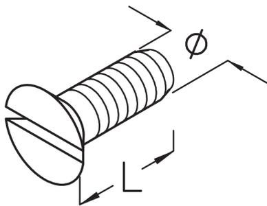
Die Senkschraube SSV (gemäß DIN 963) ist in Längen von 10 bis 40 mm sowie mit Gewinden M6 und M8 verfügbar. Verschiedene Materialien und Oberflächen sorgen dafür, dass die Korrosionsschutzanforderungen unterschiedlichster Anwendungsgebiete erfüllt werden.
