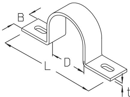
Mithilfe der Rohrschelle SRS-R wird das Schutzrohr an der entsprechenden Kabelbahn oder an der Wand bzw. am Mauerwerk befestigt. Sie steht mit Durchmessern von 30 oder 60 mm zur Verfügung. Verschiedene Materialien und Oberflächen sorgen dafür, dass die Korrosionsschutzanforderungen unterschiedlichster Anwendungsgebiete erfüllt werden.
