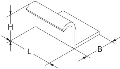
Mithilfe der Schiffskabelleiter-Winkel SLW lassen sich Schiffselektrokanäle an Wänden oder Unterkonstruktionen wie Konsolen befestigen. Verschiedene Materialien und Oberflächen sorgen dafür, dass unterschiedliche Korrosionsanforderungen erfüllt bzw. weitere Schutzmaßnahmen getroffen werden können.
