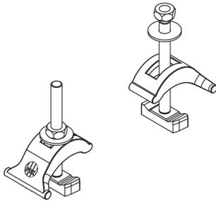
Das Trägerklemmenset SKS H dient der Montage der KIS-Konsole oder von Konsolträgern KDU und KDI an Stahlträgern. Es ist mit der Montageschiene KHA 2 kombinierbar. Das Set ist bis max. 20 kN belastbar. Der Klemmbereich erstreckt sich von 10 - 30 mm. Verschiedene Materialien und Oberflächen sorgen dafür, dass die Korrosionsschutzanforderungen unterschiedlichster Anwendungsgebiete erfüllt werden.
