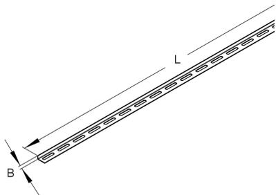
Mithilfe des Schiffskabelleiter-Trennstegs SKLT lassen sich Kabel und Leitungen mit unterschiedlichen Funktionen oder Spannungen räumlich getrennt voneinander in der gleichen Schiffskabelleiter führen. Der Trennsteg wird dreimal mit der Leiter verschraubt: in der Mitte sowie an den jeweilig letzten Sprossen der beiden Trennsteg-Enden. Er ist 10 mm hoch und 3000 mm lang.
