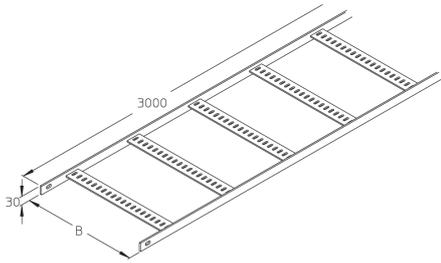
Die Schiffskabelleitern SKL mit gelochten und geschweißten Sprossen aus Flachstahl haben eine Holmhöhe von 30 mm und sind in Bahnbreiten von 75 bis 500 mm sowie in einer Länge von 3000 mm erhältlich. Verschiedene Materialien und Oberflächen sorgen dafür, dass unterschiedliche Korrosionsanforderungen erfüllt bzw. weitere Schutzmaßnahmen getroffen werden können.
