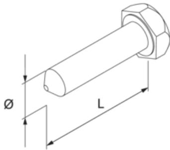
Die Sechskantschraube mit Spitze findet unter anderem in Klemmbefestigungen Anwendung und dient dem sicheren Halt auf diversen Oberflächen.
