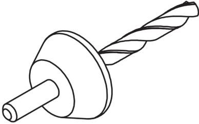
Der Stahlbetonbohrer SAZ-B ist ein Spezialbohrer zur Herstellung hinterschnittener Bohrlöcher in Beton zur Verarbeitung der SAZ Innengewindeanker. Die Herstellerangaben sind zwingend einzuhalten. Er besteht aus galvanisch verzinktem Stahl mit SDS-Plus-Aufnahme. Der Bohrer ist in den Durchmessern 8, 10 und 12 mm verfügbar.
