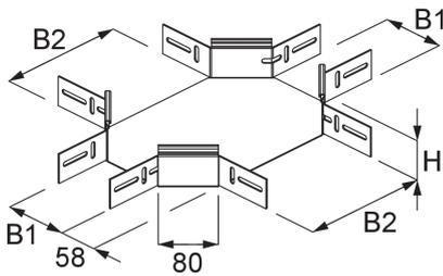
Die Installationskabelrinnen-Kreuzung RIK 60 ermöglicht den Anschluss von vier Kabelrinnen und damit die horizontale Richtungsänderung der Kabelführung. Sie hat integrierte Seitenverbinder und wird zusammen mit Bodenverbindern VB in die Kabelrinnen geschoben und verschraubt. Die Kreuzung eignet sich für Installationskabelrinnen mit einer Seitenhöhe von 60 mm und besteht aus sendzimir-feuerverzinktem Stahl.
